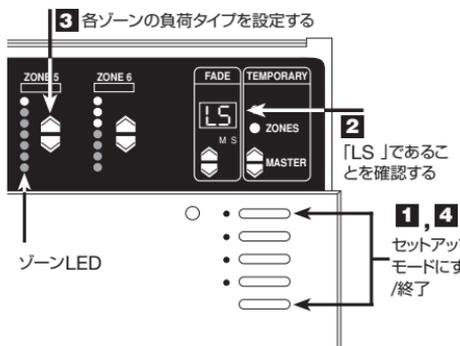
1. **セットアップ・モードにする。** シーン LED が循環点減するまで、シーン 1 とオフボタンを約 3 秒間押し続けます。
