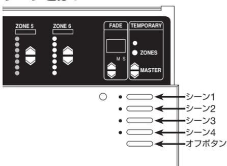
シーンとは、あらかじめコントロールユニットに設定された、各照明ゾーンの照明パターンです。さらに、電動カーテン/ロールスクリーンシーンをルートロンの照明コントロールシステム統合することで、照明のシーンに連動させてお好みの位置に設定することもできます。シーンを再現するには、シーンボタンを選択するだけです。1 番目のボタンがシーン 1 を、2 番目がシーン 2 を呼び出す、といった具合です。コントロールユニットでは最高で 16 シーンまで設定可能です。シーン 1 ~ 4 はコントロールユニットで、シーン 5 ~ 16 は補助コントロールを使用します。
