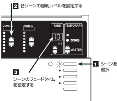
\* FADE 表示窓にある S と M は、フェードが S (秒)、M (分) のどちらであるかを表示します。フェードを分に設定するには、FADE ▲ を押して、1~59 秒、... M までスクロールします。これでフェードは分単位で表されます。秒単位に戻るには、表示が S を表示するまで FADE ▼ を押してください。工場出荷時のフェード時間はすべて 3 秒に設定されています。
