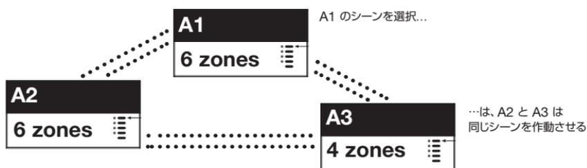
双方向コミュニケーションでリンクさせると、これらのコントロールユニットは、16ゾーンのコントロールユニットのように動作します。すべてのコントロールユニット間で、双方向コミュニケーションをセットアップする必要があります。
