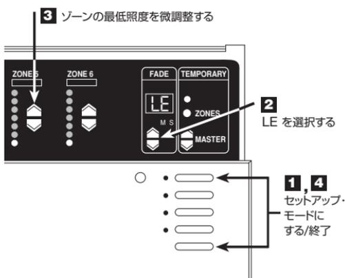
必要に応じて、(特にネオン/冷陰極管や蛍光灯負荷を使用する場合)最低照度の微調整を行います。
